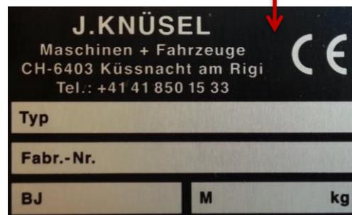
Bei der Bestellung von Ersatzteilen sind die Typenbezeichnung, die Maschinenummer und das Baujahr anzugeben. Diese Angaben finden Sie auf dem Typenschild.
