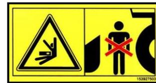
Niemals in den Gefahrenbereich zwischen Anbaugerät und Maschine treten.
