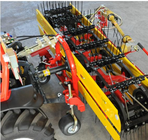
Ce système de bras supérieur permet de transférer jusqu'à 70% du poids du dégrilleur sur le véhicule porteur. Le dégrilleur peut être transféré sur le véhicule. Le dégrilleur glisse légèrement en suspension avec les roues de jauge. Cela permet de conduire de manière plus sûre et plus raide.
