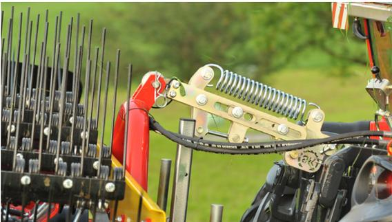
Mit diesem Oberlenkersystem kann bis zu 70% vom Bandrechengewicht auf das Trägerfahrzeug übertragen werden. Der Bandrechen gleitet leicht schwebend mit den Tasträdern über die Unebenheiten im Gelände. Dadurch kann sicherer und steiler gefahren werden.
