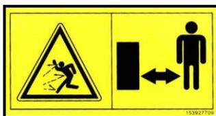
Gefahr durch fortgeschleuderte Teile bei laufendem Motor – Sicherheitsabstand halten.
