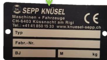
Bei der Bestellung von Ersatzteilen sind die Typenbezeichnung, die Maschinenummer und das Baujahr anzugeben. Diese Angaben finden Sie auf dem Typenschild.
